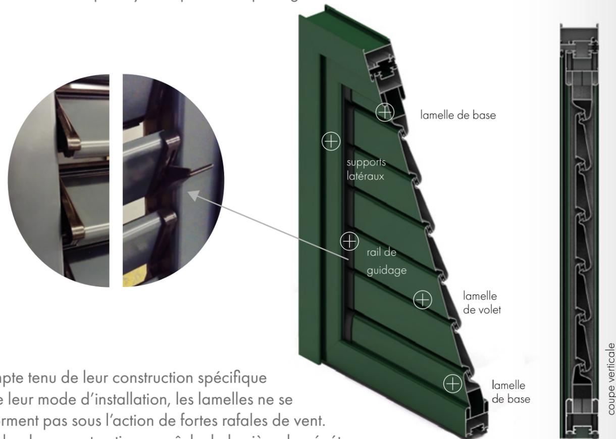
Compte tenu de leur construction spécifique et de leur mode d'installation, les lamelles ne se déforment pas sous l'action de fortes rafales de vent. De plus, leur construction empêche la lumière de pénétrer à l'intérieur.
