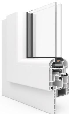
Profilé qui permet d'installer des fenêtres dans des bâtiments existants sans avoir à retirer les anciens cadres. L'aile de recouvrement recouvre l'ancien cadre à l'intérieur du bâtiment, et des profils supplémentaires spéciaux le masquent à l'extérieur.
