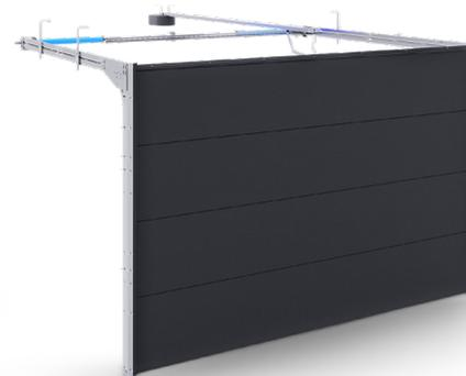
L'emplacement des ressorts de torsion à l'arrière de la porte permet de l'adapter à une ouverture de garage avec un linteau inférieur. Ces portes peuvent être réalisées dans des dimensions plus importantes avec le même linteau, par rapport aux portes avec ressorts de tension, qui sont conçues pour 25 000 cycles. Dans ce cas, il suffit que le linteau soit de 90 mm (120 mm dans le cas d'une motorisation électrique). Charge maximale jusqu'à environ 165 kg.
