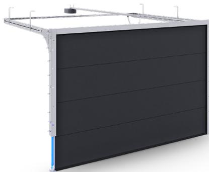
Les ressorts de traction sont recommandés pour l'installation dans les garages dont la surface de porte est petite. L'installation est rapide et ne nécessite pas d'enroulement spécial des ressorts, qui sont conçus pour 15 000 cycles. Un mécanisme à double ressort (appelé "ressort dans le ressort") est utilisé ici, ce qui permet une capacité de levage d'environ 130 kg pour le tablier.
