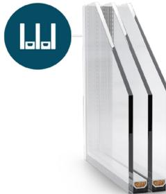
Un vitrage isolant à deux chambres composé de trois vitres. Il s'agit d'une norme pour les systèmes de portes et fenêtres aux propriétés thermiques améliorées. L'espace entre les vitres, créé par l'intercalaire, est principalement constitué d'argon (90%), ce qui réduit encore le coefficient de transfert thermique  $U_g$ .
