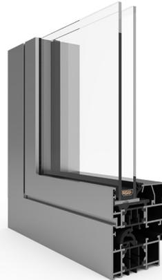
Le profilé est fabriqué en aluminium à l'intérieur et à l'extérieur. Dans la partie centrale, il y a une rupture de pont thermique, ce qui augmente considérablement l'isolation thermique des profilés.
