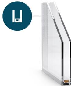
Un vitrage à une chambre composé de deux vitres. Il s'agit d'une norme pour les systèmes de fenêtres et de portes de base. Dans l'espace entre les vitres, créé par l'intercalaire, il y a majoritairement de l'argon (90%), ce qui réduit en outre le coefficient de transfert thermique  $U_g$ .
