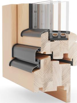
Une version du profil qui permet d'installer de nouvelles fenêtres dans des bâtiments existants sans avoir à démonter les anciens dormants en bois. Possibilité d'utiliser différentes longueurs de l'aillette de rénovation pour recouvrir l'ancien dormant à l'intérieur du bâtiment.
