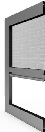
Elle complète la gamme de moustiquaires plissées et est conçue principalement pour être installée sur les cadres de fenêtres et les fenêtres de toit. La fermeture et l'ouverture sont très faciles et fluides grâce aux ressorts situés dans le profilé inférieur. Dimension maximale 2300x2000 mm.
