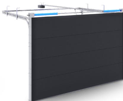
Les ressorts de torsion sont destinés aux portes de différentes tailles. Ils soulèvent beaucoup plus de poids que les ressorts de traction, qui sont conçus pour 25 000 cycles. L'installation est possible lorsque la hauteur du linteau est d'au moins 200 mm. Le poids maximal de la porte est d'environ 295 kg.
