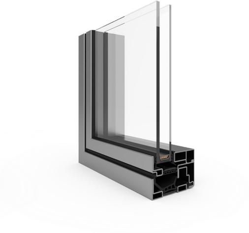
Le profilé est en acier à l'intérieur et à l'extérieur. Dans la partie centrale, il y a un intercalaire thermique, ce qui augmente considérablement la performance d'isolation thermique du profilé.
