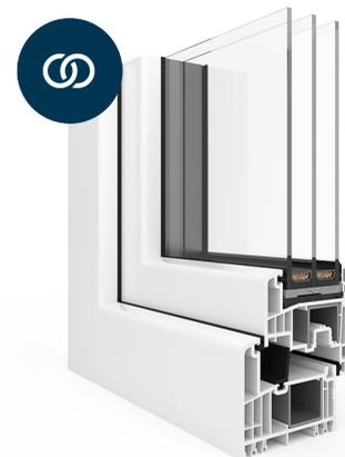
La technologie de collage de vitrage à sec. Le choix de cette solution permet d'augmenter la taille maximale de la fenêtre, tout en assurant un montage et un démontage faciles du vitrage utilisé.
