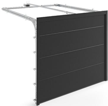
Des éléments de montage spéciaux créent un espace supplémentaire entre le mur et les rails, ce qui permet d'installer une porte de garage sectionnelle R ou X. Cette solution est idéale pour les projets de rénovation et les garages tunnels. Pour des hauteurs de porte jusqu'à 3 m et des largeurs jusqu'à 5,5 m.
