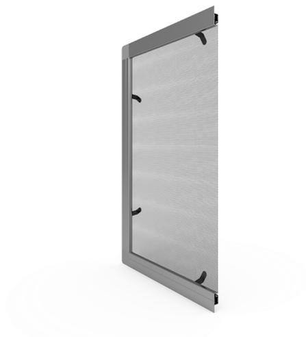
La moustiquaire est conçue pour être installée dans les fenêtres en PVC et est disponible dans des couleurs imitation bois. Les profilés peuvent être assemblés à un angle de 90° avec un coin en plastique ou à un angle de 45° avec un coin intérieur. Ce sont les seules moustiquaires qui peuvent être adaptées aux modèles de fenêtres atypiques.
