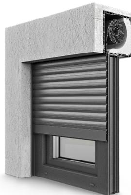
Le système offre une excellente protection contre les facteurs externes et améliore considérablement l'isolation thermique du bâtiment, tout en augmentant l'isolation acoustique, ce qui réduit sensiblement le niveau de bruit dans les pièces. Un élément reconnaissable et particulièrement caractéristique du système est la trappe de visite située à l'intérieur de la pièce.
